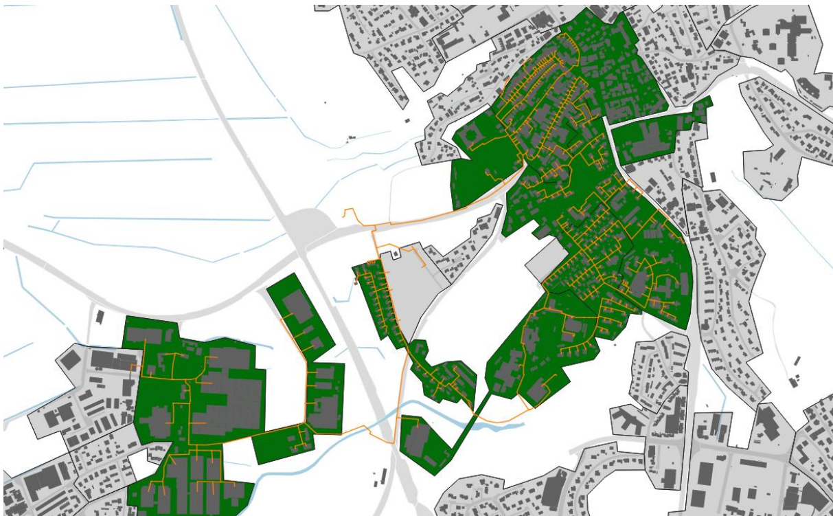
Abbildung 1: Aktuelles Wärmenetzerschließungsgebiet mit Trassenverlaufplan (Stand: 11/2025)
