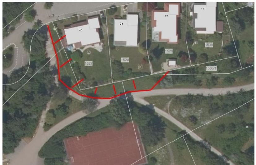
Abbildung 13: Der Reptilienschutzzaun soll in diesem Bereich aufgebaut werden, um eine Auswanderung der Zauneidechsen in die Baustelle zu vermeiden. Quelle: Geobasisdaten © Landesamt für Geoinformation und Landentwicklung Baden-Württemberg, www.lgl-bw.de , Az.: 2851.9-1/19.
