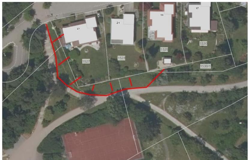
Abbildung 13: Der Reptilienschutzzaun soll in diesem Bereich aufgebaut werden, um eine Auswanderung der Zauneidechsen in die Baustelle zu vermeiden. Quelle: Geobasisdaten © Landesamt für Geoinformation und Landentwicklung Baden-Württemberg, [www.lgl-bw.de](http://www.lgl-bw.de), Az.: 2851.9-1/19.
