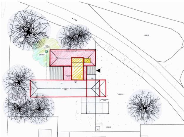
Die Unterbringung der Gruppen in einer Interimslösung ist nicht erforderlich. Im laufenden Betrieb sind die Umbauarbeiten zeitlich eingrenzbar. Die WC-Anlagen im Querbau-Bestand sollen demontiert und in den späteren Schlafraum, neben der jetzigen Küche eingebaut werden. So kann die Betreuung unabhängig von Wind und Wetter weiterhin gewährleistet werden.
